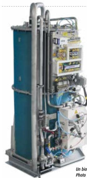
Un bioréacteur Protec pour un montage à l'intérieur
